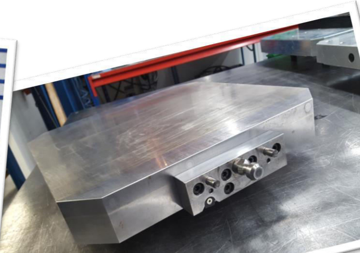
Sondermagnetpalette mit Spezialekupplung für Erodierarbeiten
