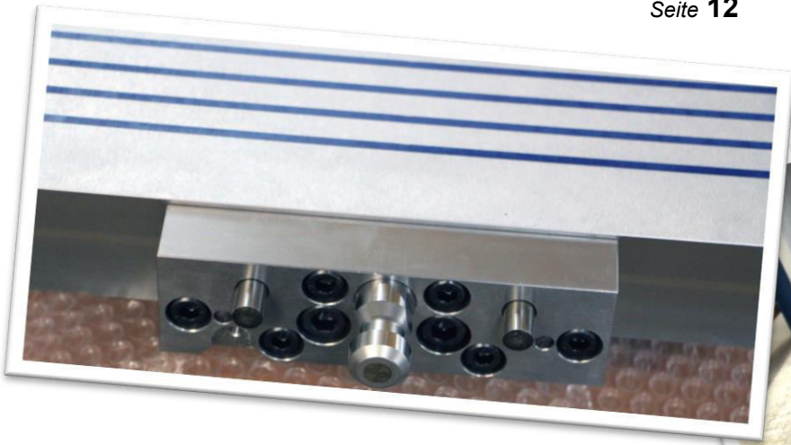
Sondermagnetpalette mit Spezialekupplung für Erodierarbeiten
