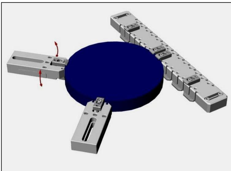
Werkstückspannung eines runden Werk-
