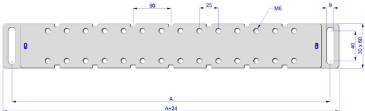
**Maß -A ist der Abstand der Gewinde M8 auf dem Maschinentisch über die Y-Achse (vordere Reihe)**
